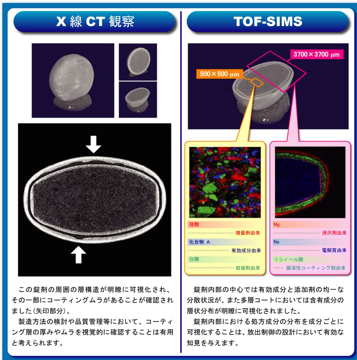
X線CT観察とTOF-SIMSを用いることにより、錠剤内部における放出制御の為に構造や薬剤成分を可視化し、製剤化コンセプトとテストサンプルとの比較等、効果的な製剤開発サポートする為の解析手段を提供致します。
