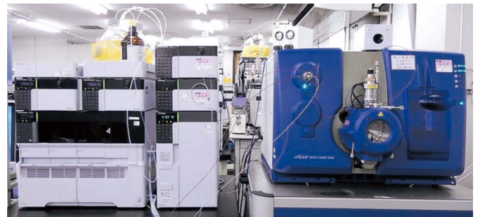
測定機器 HPLC: Nexera X2システム(島津製作所) MS: TripleQuad 6500 (AB Sciex)
