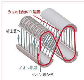
図2 イオン飛行部の模式図
