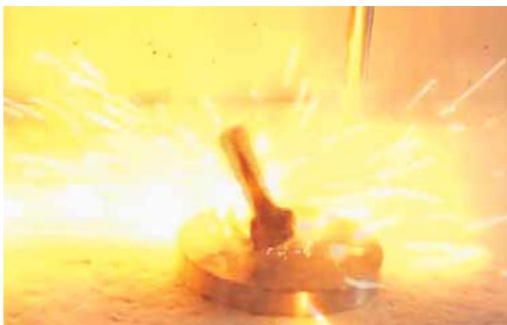
図2 衝撃感度体感教育 (酸化剤と可燃物の混合物)
