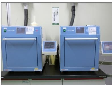
マイクロウェーブ試料前処理装置
