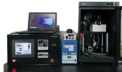
図1 樹脂硬化収縮率応力測定装置外観
