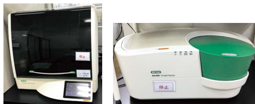
図4 ドロップレットデジタルPCRシステム QX200™ AutoDG™ Droplet Digital™ PCR System (バイオ・ラッドラボラトリーズ株式会社)
