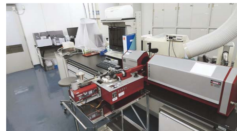
図3 レーザー回折式粒度分布計 HELOS-KF-M (Sympatec GmbH)
