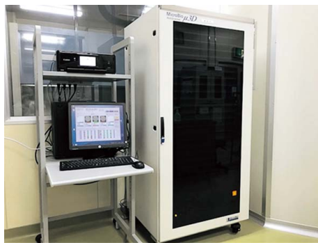
図5 無菌試験迅速測定装置(マイクロバイオμ3D)
