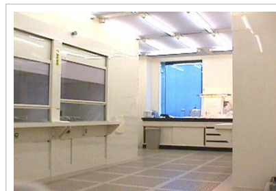
メタルフリー仕様クリーンルーム
