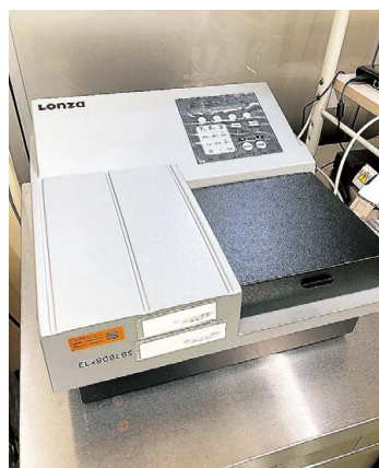
図4 エンドトキシン測定装置
