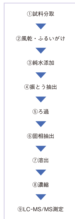
図2 土壌溶出量試験の試験フロー
