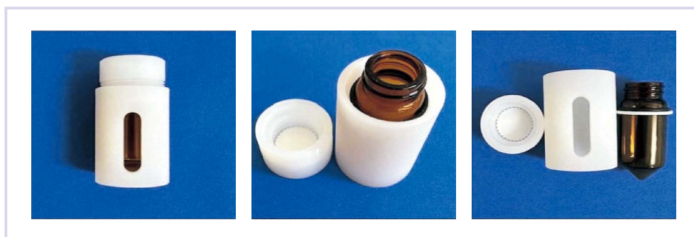
図4 民間企業との共同研究事業で開発したPFAS標準品専用の高気密瓶
