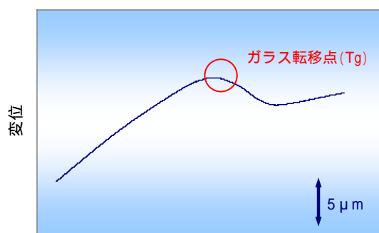
図 6：多層基板の TMA 測定チャート
