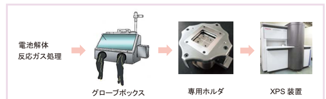
図2 大気非曝露によるXPS分析の流れ
