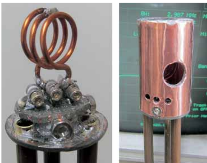
図2 RF probeの例 (内径は12.5 mm)
