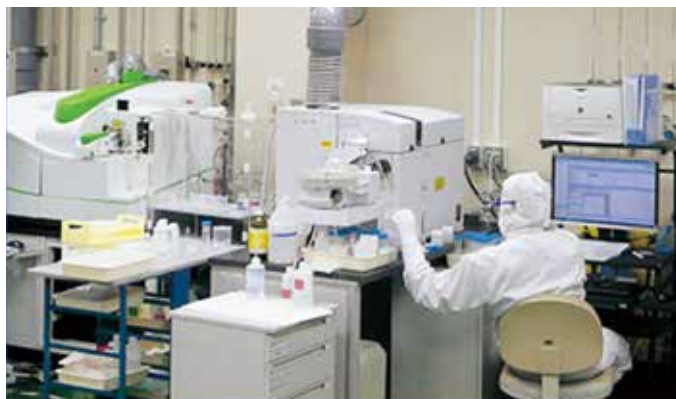
図3 クリーンルーム内でのICP-MSによる測定作業 (大阪事業所)
