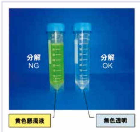
図6 マイクロ波分解による分解液
