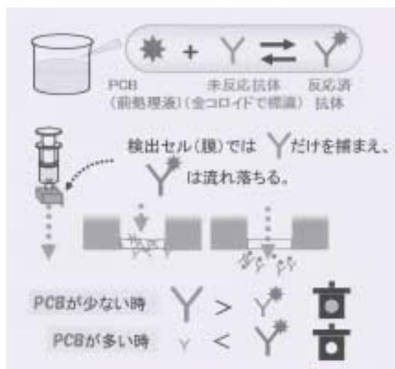
図1 PCBセンサーの測定原理
