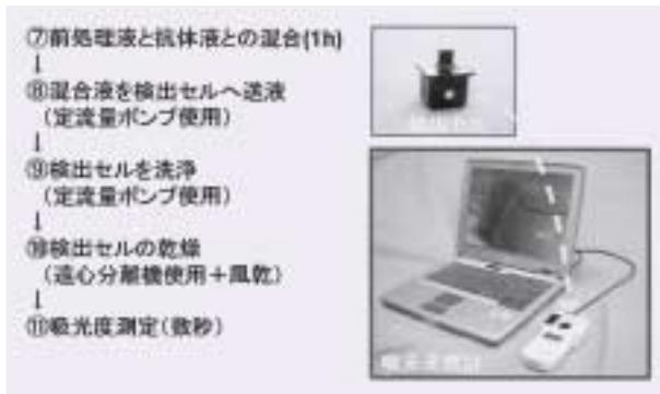
図3 測定方法の簡易操作フロー
