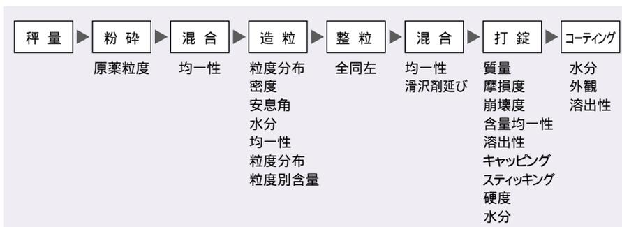
図6 固形製剤の製造プロセスと関係する製剤特性
