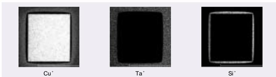
図11 TOF-SIMSによるディッシング評価例
