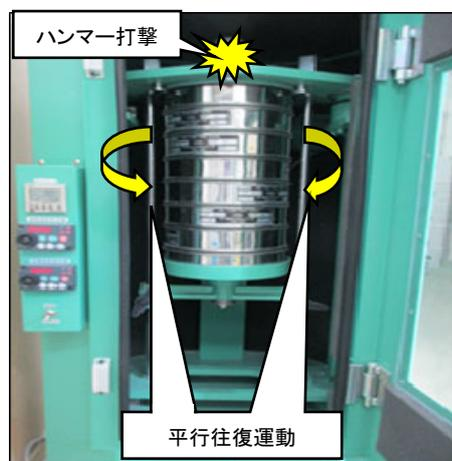
Fig. 2 ロータップ式振とう機とふるい網
