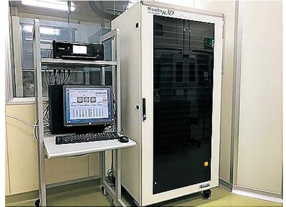
図2 無菌試験迅速測定装置（マイクロバイオμ3D™）
