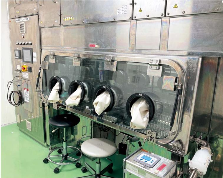
図1 無菌試験用アイソレータシステム（追加導入した2号機）
