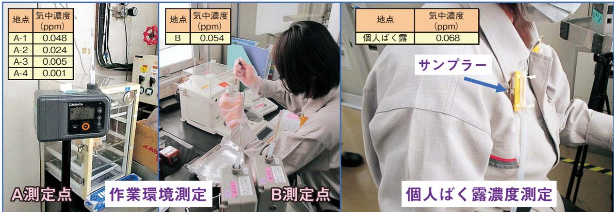
図2 作業環境測定および個人ばく露濃度測定での測定状況と結果
