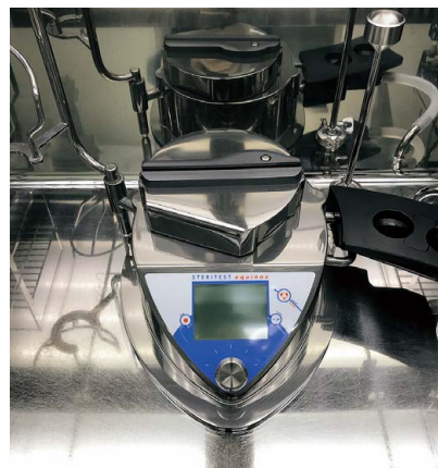
図2 メンブランフィルター法 (Steritest Equinox アイソフィットポンプ) - MERCK社ステリテストを用いたメンブランフィルター用ポンプ
