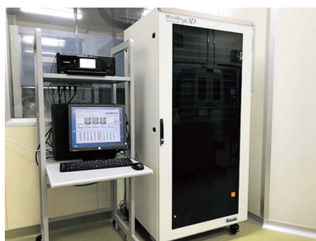
図5 無菌試験迅速測定装置(マイクロバイオ3D)
