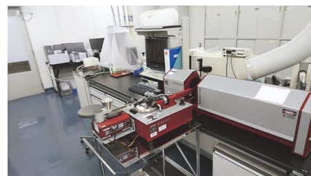
図3 レーザー回折式粒度分布計 HELOS-KF-M (Sympatec GmbH)
